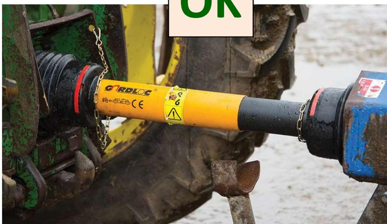
**I tubi telescopici di protezione dell'albero cardanico devono essere integri, privi di deformazioni, slabbrature, ammaccature, ecc.** Qualora uno di questi inconvenienti venga rilevato, bisogna sostituire l'intera protezione.
