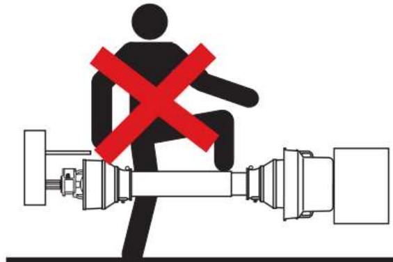
**Non utilizzare i tubi telescopici come punto d'appoggio per la salita o la discesa dalla macchina, sia con albero cardanico fermo, sia tanto meno quando è in movimento.**
