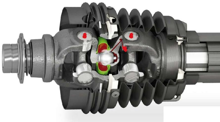
Il **giunto omocinetico è quindi un doppio giunto, con due forcelle esterne collegate con due crociere ad un corpo centrale**, costituito da un disco e due forcelle interne, solidali ad esso. Il dispositivo è autosupportante e presenta una tipica conformazione a "botte" del corpo centrale. Questa forma non è casuale, ma è opportunamente studiata in modo da permettere, in manovra, un angolo di lavoro massimo di ben 80°.
